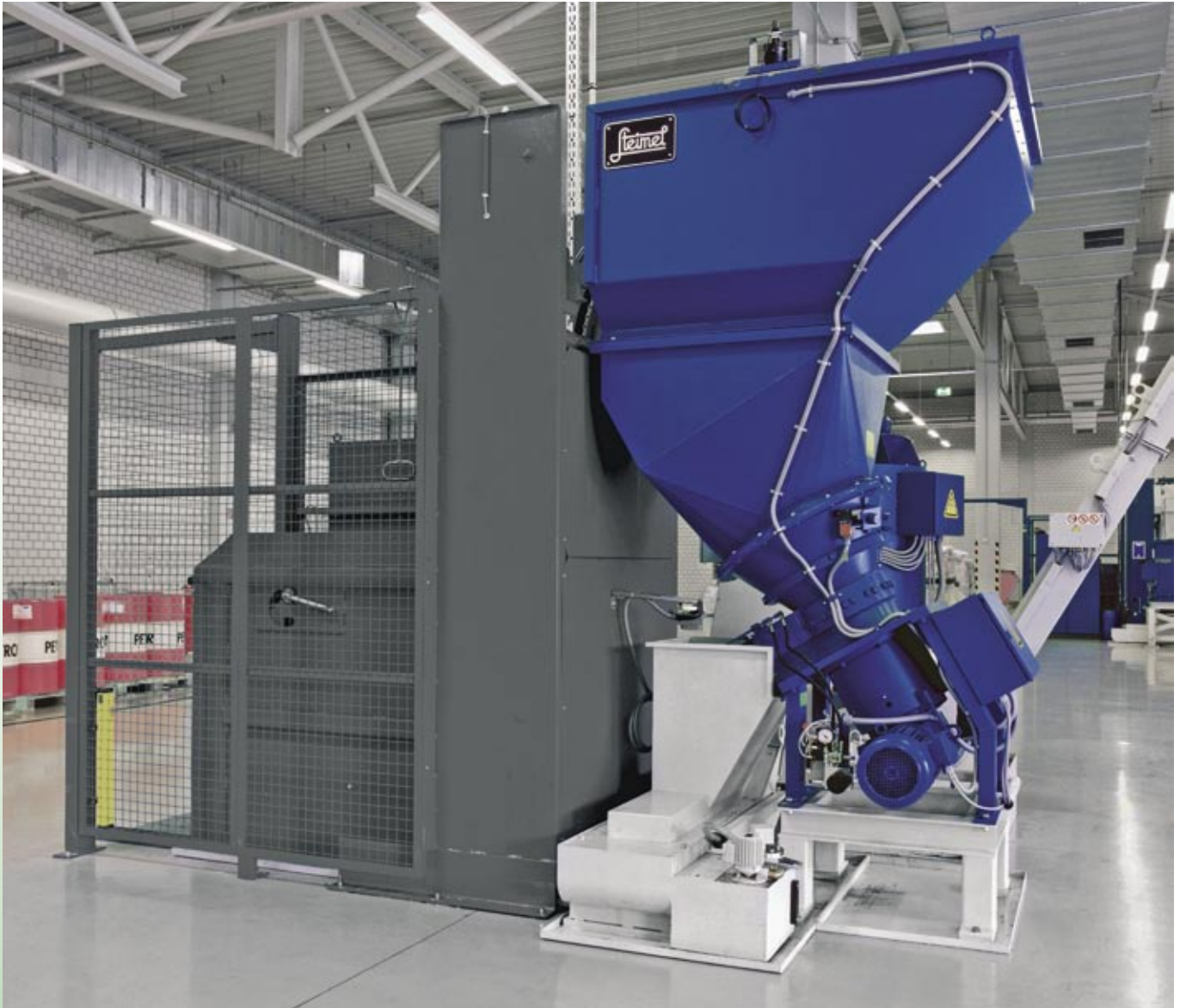
Molino de virutas RS 300 E en una instalación de tratamiento de virutas compuesta por: elevador basculante, molino de virutas RS 300 E, transportador rascador, centrifugadora Permolex Polar K 51 y transportador rascador con tubo giratorio para la evacuación a los contenedores in situ.
