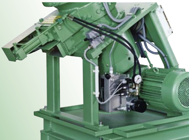
Equipo hidráulico y dispositivo de descarga para piezas gruesas E en el molino de virutas RS 300 E
