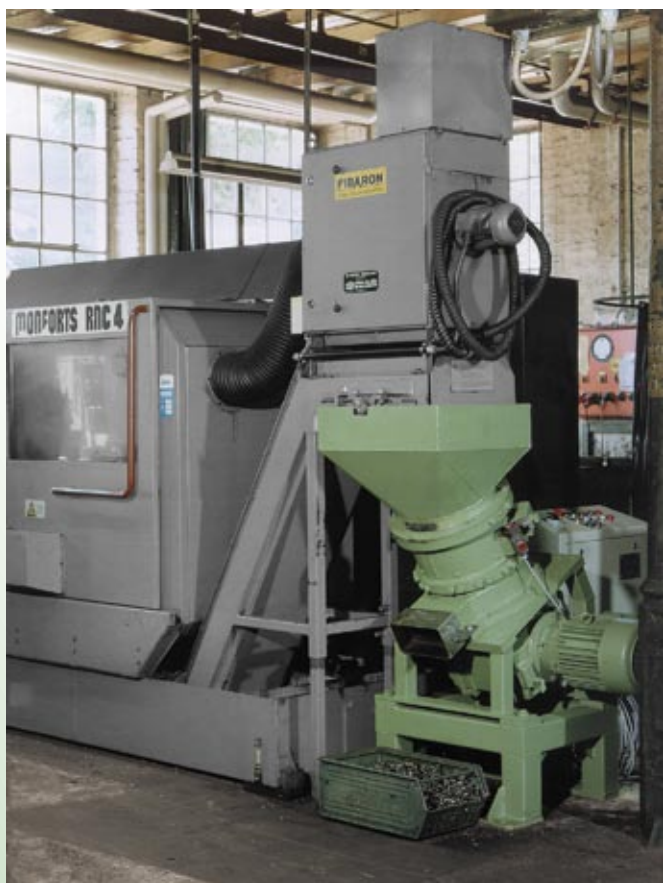
El molino de virutas RS 300 K aquí representado (verde) se carga directamente por el transportador de salida de una máquina procesadora NC.
